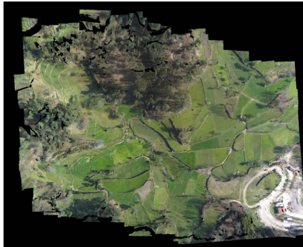
Figura 2 - Ortofoto resultante do processamento em MicMac
